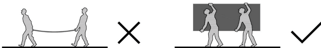
Figura 1.14 – Manuseamento dos painéis Viroc
